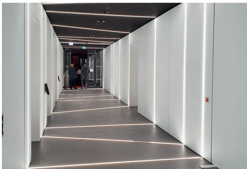
▲ Anwendung in einem modernen Bürogebäude, welches das Soloblu-System von Greentec integriert hat. In Arbeitsbereichen mit ausreichend Tageslicht wird die künstliche Beleuchtung automatisch angepasst, um den Energieverbrauch zu minimieren.
