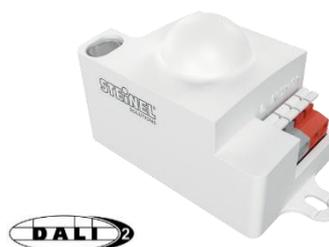
HF-Sensor mit Stabantenne für max. 8m Erfassungsbereich und einer DALI-Steuerung mit Konstantlichtregelung.
