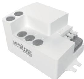
HF-Sensor mit Patchantenne für max. 5m Erfassungsbereich und einer Steuerung des 230V Relais.
