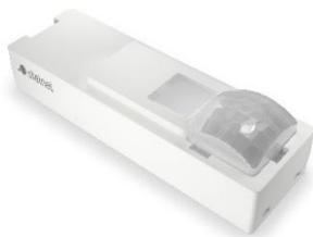
Der unauffällige PIR-Präsenzmelder mit einem Erfassungsbereich von 4x4m (Bewegung 6x6m) ist ein kompakter und verlässlicher Leuchteneinbau-Sensor für Anwendungen bis zu einer max. Höhe von 5m.
