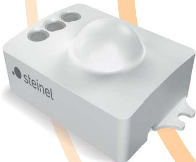
▲ Der HF2 NET ist ein für Einbau-Anwendungen konzipiertes Hochfrequenz-Sensormodul. Die Erfassung erfolgt durch Glas und alle anderen nicht-metallischen Materialien, so dass die Module problemlos im Inneren von Leuchten oder anderen Produkten verwendet werden können.
