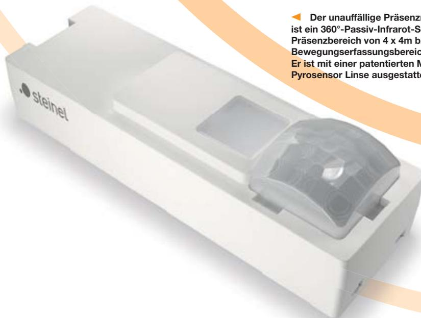
◀ Der unauffällige Präsenzmelder PIR NET ist ein 360°-Passiv-Infrarot-Sensor mit einem Präsenzbereich von 4 x 4m bzw. einem Bewegungserfassungsbereich von 6 x 6m. Er ist mit einer patentierten Multisegment-Pyrosensor Linse ausgestattet.
