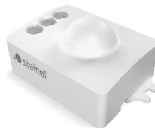
Das HF-Sensormodul hat einen Erfassungsbereich bis 8m bei einer max. Höhe von 3.5m. Die Präsenz-Erfassung erfolgt durch Glas und nicht-metallische Materialien und kann somit im Inneren von Leuchten verwendet werden.
