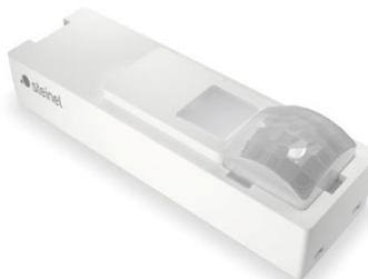
Klein. Flach. Kompakt. Unauffälliger Präsenzmelder. 360°-Passiv-Infrarot-Sensor IR mit einem Präsenzbereich von 4 x 4m (präsenz und radial) bzw. 6 x 6m (tangential). Mit patentiertem Multisegment-Pyrosensor Linse.
