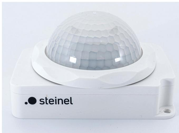
▲ Der Highbay Sensor HB PIR 3360 ist quasi schwindelfrei und damit ideal für hohe Decken in Industriehallen oder Gewerbeimmobilien bis 14m Montagehöhe. Der hochpräzise 360°-Infrarot-Sensor hat eine Erfassung mit 36m Durchmesser und Flächen von bis zu 1.000m<sup>2</sup>.
